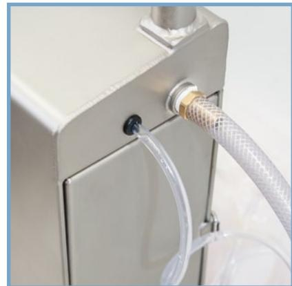
Separate Zuführung der Reinigungsmittel
