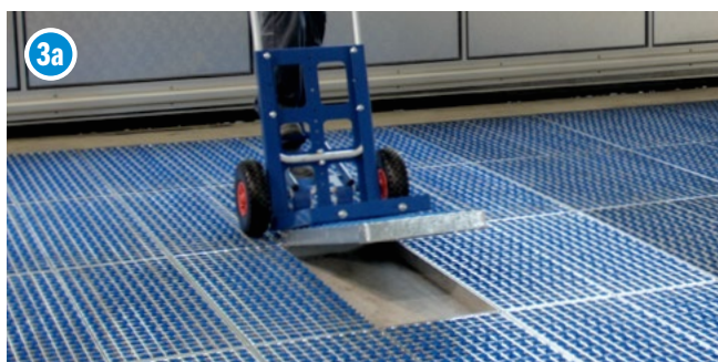
A rostély visszahelyezése emelőkocsival. Re-insert of the grates with lifter. Izgaraları kaldırıncı ile tekrar yerleştirin. Réinsérez les grilles dans les bacs à l'aide du Lifter. Vuelva a insertar las rejillas con el levantador. Reinserire le griglie con il sollevatore.
